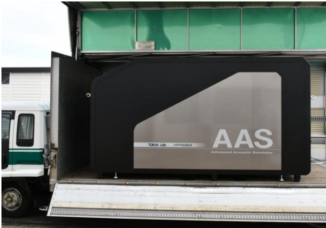
高さ 2.4m 長さ 4.2m 幅 2.3m 重さ 2400kg 4トラックに乗せたまま、拠点をまたいだ運用も可能
