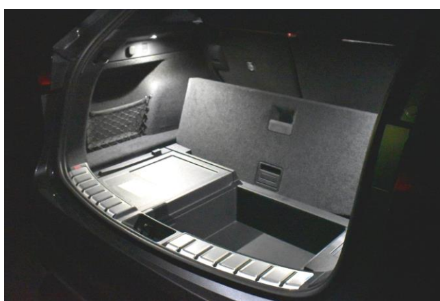
デッキボードは3つ折りで、デッキ下収納に引っかけて自立します。ハンドルを2カ所に配置し、無理な姿勢なく片手でスマートに開閉可能。
